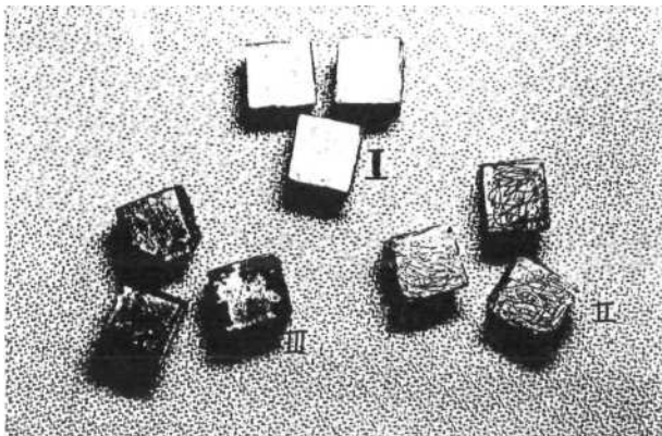
Şekil 3. Kesme tipi yüklem testi sonucu örnek yüzeyleri (I: Kumlanmış, II: Elmas ile pürüzlendirilmiş, III: Oksitlenmiş)
