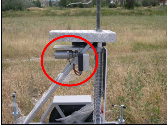
Elektrik motoru ünitesi
