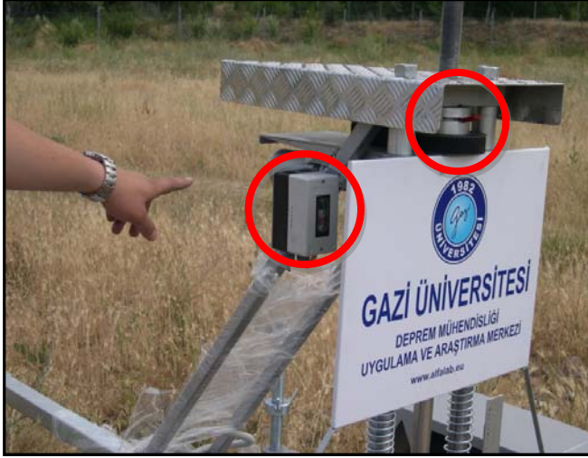
Otomatik tetikleme ve ağırlık kaldırma ve indirme sistemi
