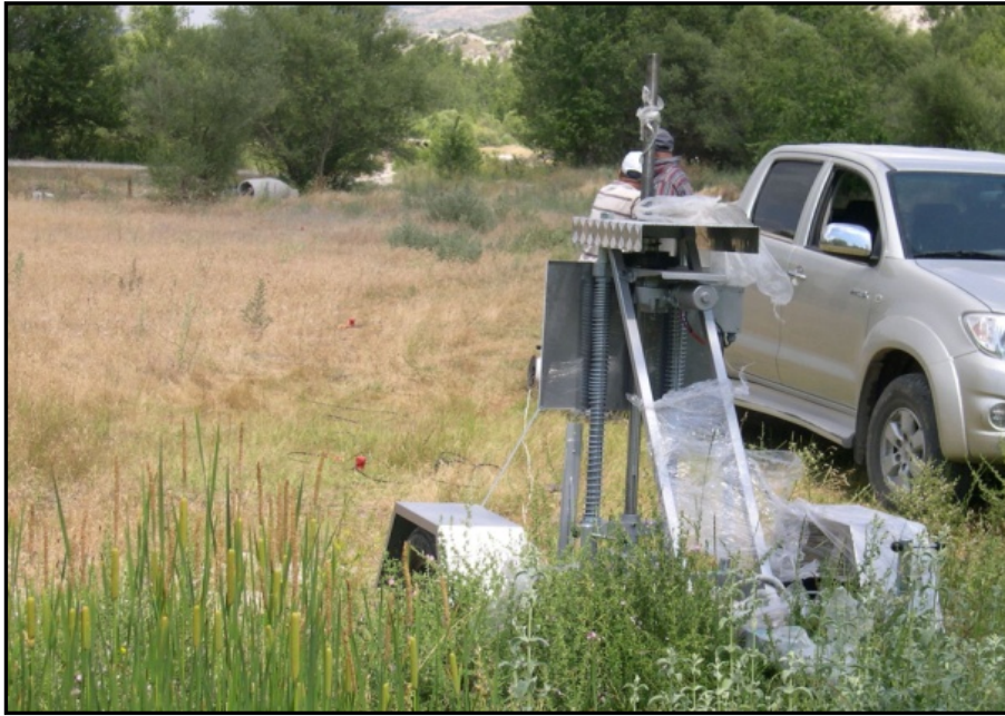
Şekil 4. MASW arazi deneyleri sırasında enerji kaynağı olarak kullanılan ağırlık düşürme düzeneğinin resimleri.
