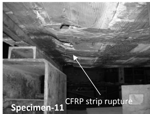
Şekil 8. Ankrajlı CFRP şeritler ile güçlendirilen deney elemanlarının göçme modunda alınmış fotoğraflarından örnekler
